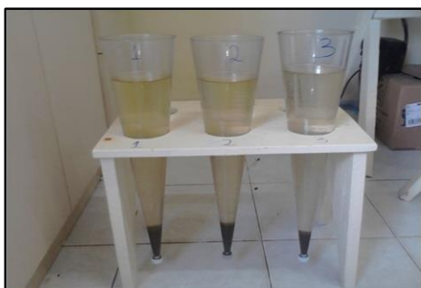
Fotos 44 e 45 – Esquema ilustrativo com cones Imhoff sendo utilizados para mensurar os sólidos sedimentáveis Fonte: SCOPEL, Bruno - 2013.
