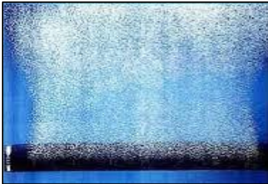
Foto 31 – Mangueira porosa de baixa pressão Fonte: Goode 2021.
