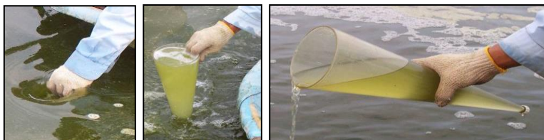
Fotos 44 e 45 – Esquema ilustrativo com cones Imhoff sendo utilizados para mensurar os sólidos sedimentáveis Fonte: SCOPEL, Bruno - 2013.
