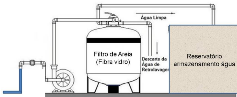
Figura 22 – Esquema ilustrativo de tratamento de água com filtro de areia Fonte: ABCC.
