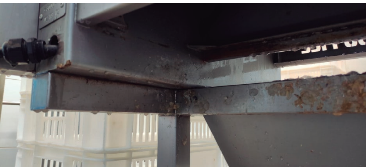
FIGURA 8 Parte inferior de máquina de remover pele/couro com incrustação de sujeira em pontos de difícil acesso para limpeza efetiva e satisfatória
