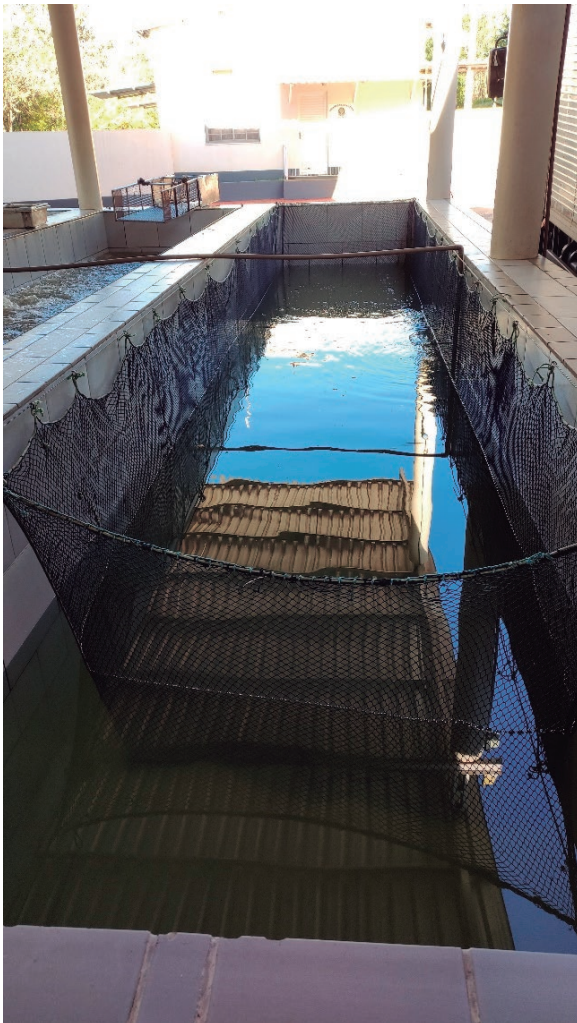
FIGURA 5 Tanque de recepção ou tanque de espera para peixes que chegam vivos da piscicultura
