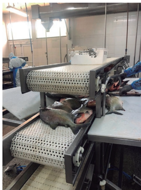
FIGURA 10 Esteira de transporte de peixes eviscerados
