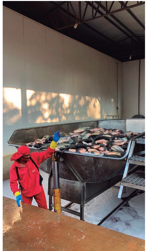
FIGURA 6 Cuba de recebimento de peixes insensibilizados por hipotermia
