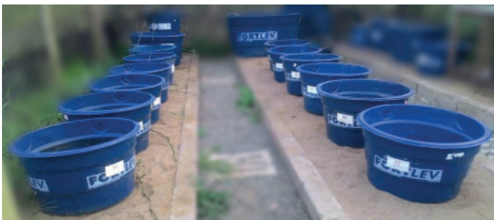
Figura 2. Distribuição das Unidades Experimentais com a utilização de tanques de polietileno de 100 litros.
