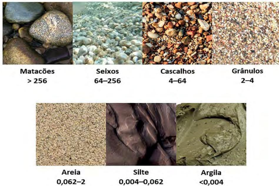
**Figura 1.4** Granulometria (mm) dos sedimentos do fundo oceânico. **Adaptado** de Turekian (1968).
