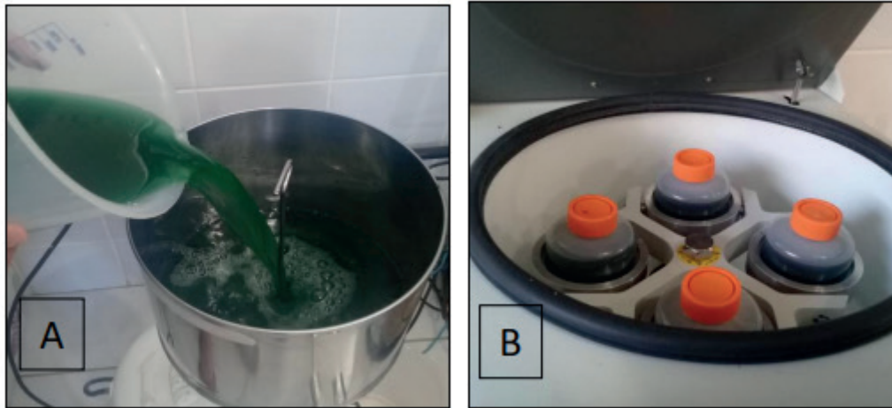
Figura 2: Volume de 10L sendo colocado na desnatadeira (A) e; Frascos cônicos de 450 mL na centrífuga (B).
