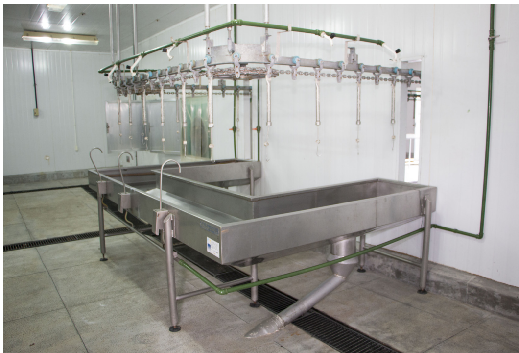
Figura 4. Área limpa industrial, onde ocorre a retirada da pele e eventração das rãs.
