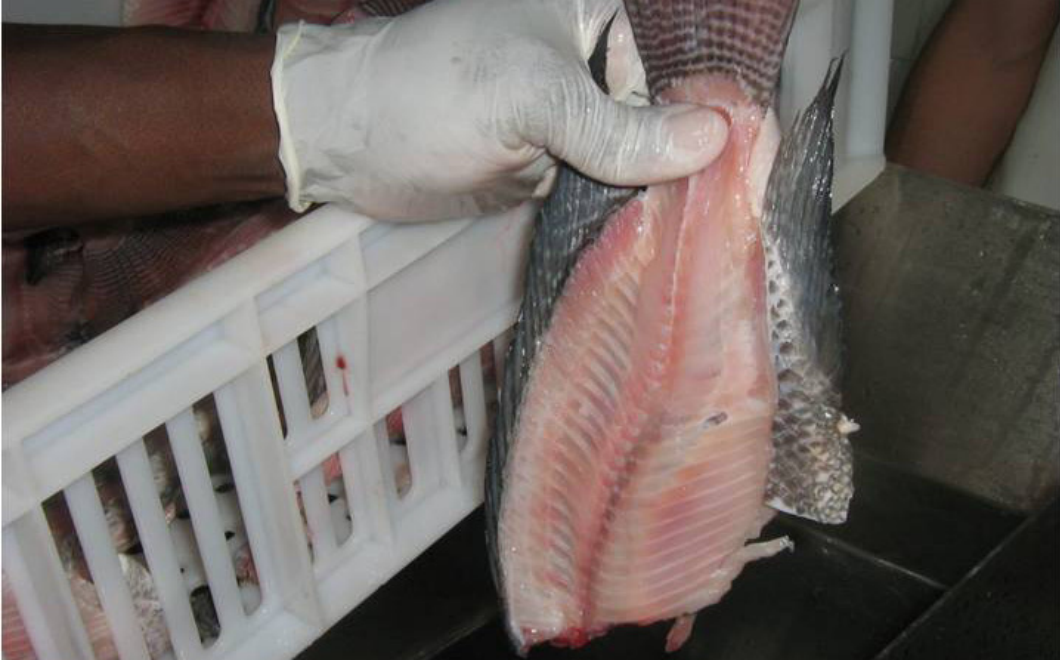
Figura 1. Espinhaço de tilápia após filetagem pronto para introdução na máquina de desossa mecânica.
