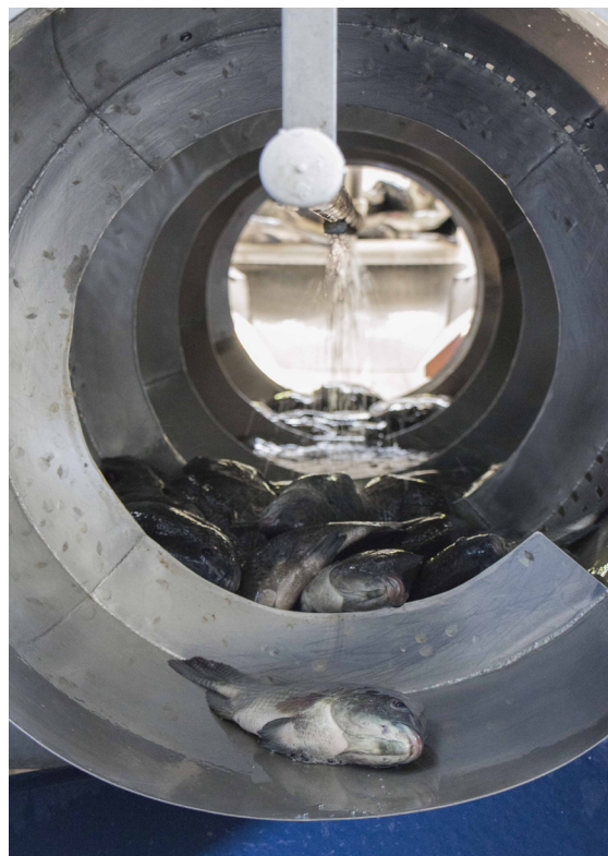
Figura 6. Cilindro de lavagem para higienização do peixe (passagem da área suja para área limpa).
