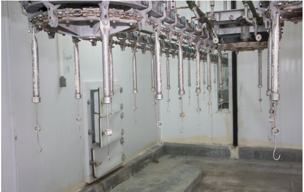
Figura 2. Área de recepção (área suja) do entreposto, onde ocorre a sangria das rãs, as rãs são dependuradas pelas patas nos ganchos da nória.
