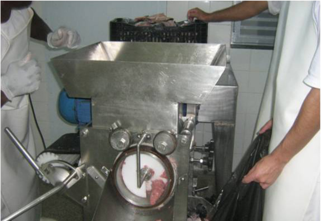
Figura 2. Máquina de desossa mecânica com cilindro e tambor, a carne desossada é recolhida na parte frontal da máquina e na lateral os resíduos são recolhidos em saco plástico preto.
