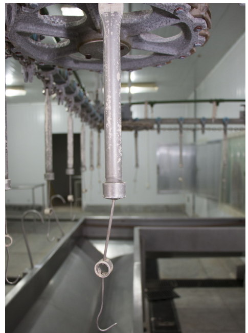
Figura 2. Área de recepção (área suja) do entreposto, onde ocorre a sangria das rãs, as rãs são dependuradas pelas patas nos ganchos da nória.
